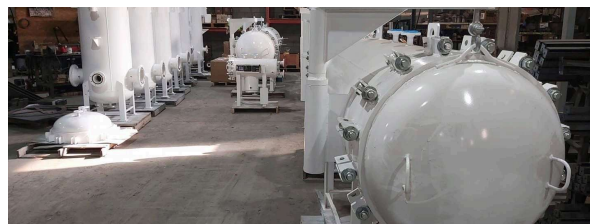
Recipientes de filtracion en fabricacion: conexiones de muestreo, indicacion de presion diferencial, liberacion de aire y drenaje completo.
